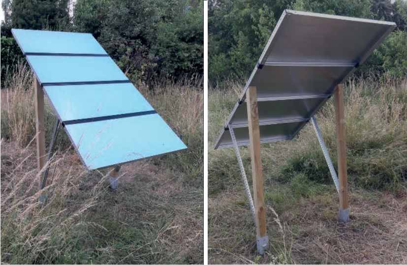
Abb. 7 Prototyp eines PV-Dummies. Links: Vorderseite, rechts: Rückseite; Maße 1 x 2 m, 80 cm Höhe der unteren Kante vom Boden. Foto: K. Baumann 2023.
